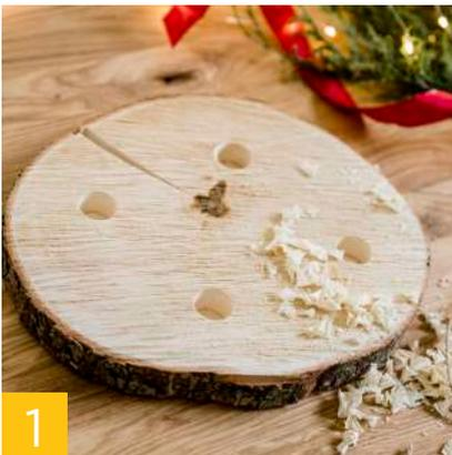
1. Vier Aussparungen in der Größe der Kerzenhalter ins Holz fräsen. Hierfür eignet sich am besten ein Forstnerbohrer (auch ugs. Astlochbohrer genannt; breiter Bohrkopf ohne Bohrgewinde).
